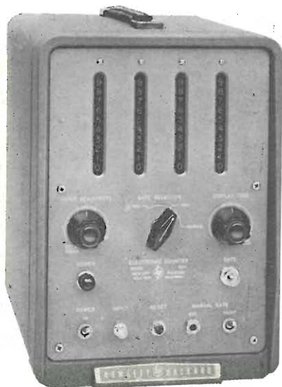
Fig. 1 - Contatore industriale Mod. 521A a quattro decadi. Si notino la regolazione della sensibilità, la scelta dell'unità di tempo durante il quale effettuare il conteggio e la regolazione del tempo di lettura.
